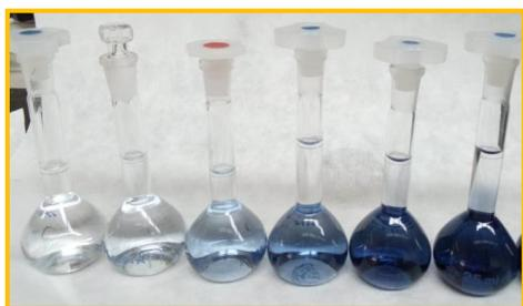
**Slika 6.** Priprema standardnih otopina za određivanje ukupnih fenola.<sup>1</sup>
