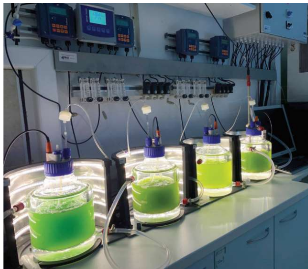
Slika 7. Serijski povezani foto-bioreaktori (Blažina, 2019)
