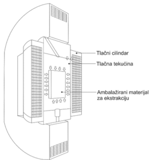
Slika 3. Presjek tlačnog uređaja za VHT
