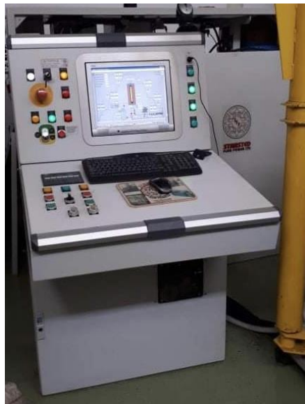
Slika 7 Laboratorijski uređaj za visoki hidrostatski tlak "Stansted Fluid Power"
