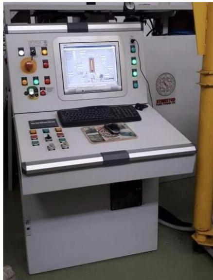
Slika 7 Laboratorijski uređaj za visoki hidrostatski tlak "Stansted Fluid Power"
