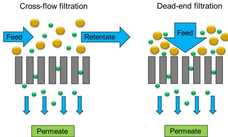
**Slika 1.** – Prikaz tangencijalne i klasične filtracije (ResearchGate.net)
