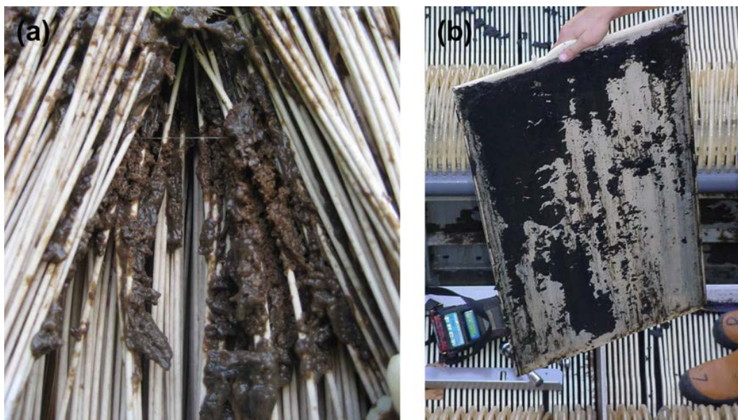
Slika 4. - Onečišćenje membrana: a) modul šuplja vlakna b) modul ravna ploča (Judd, 2006.)
