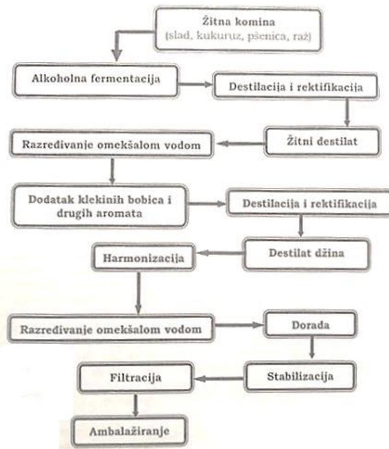
**Slika 2.** Shema tehnološkog postupka proizvodnje džina
