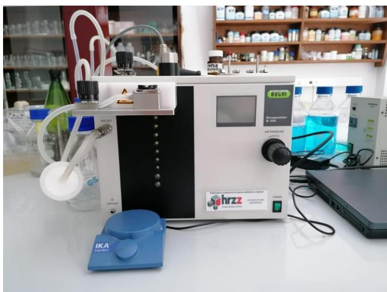
Slika 6. Inkapsulator (Büchi Encapsulator B-390)
