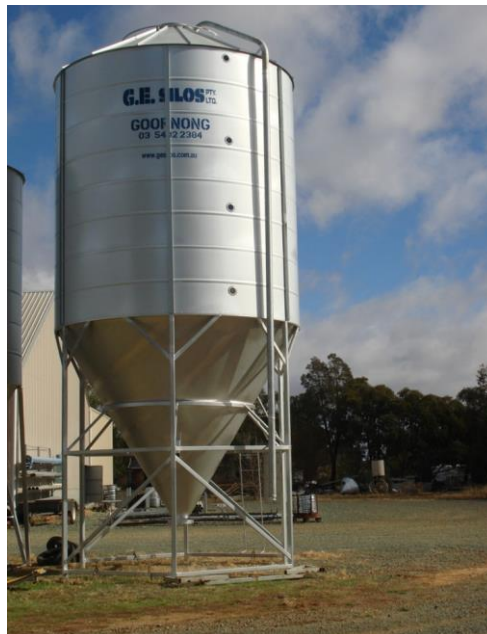
Slika 15. Čelični silos koji se koristi za skladištenje biomase u obliku kuglica (Rentizelas, 2016).
