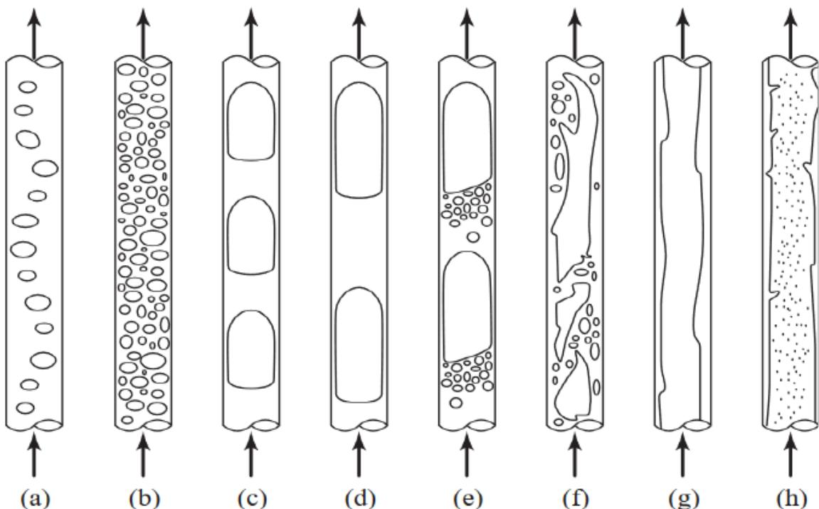
Slika 3. Prikaz uzoraka strujanja fluida: (a,b) mješuričasto strujanje, (c,d) segmentirano strujanje, (e) prijelazno segmentirano uzburkano strujanje, (f) uzburkano strujanje, (g) strujanje u filmu, (h) anularno strujanje (Kreutzer i sur., 2005)
