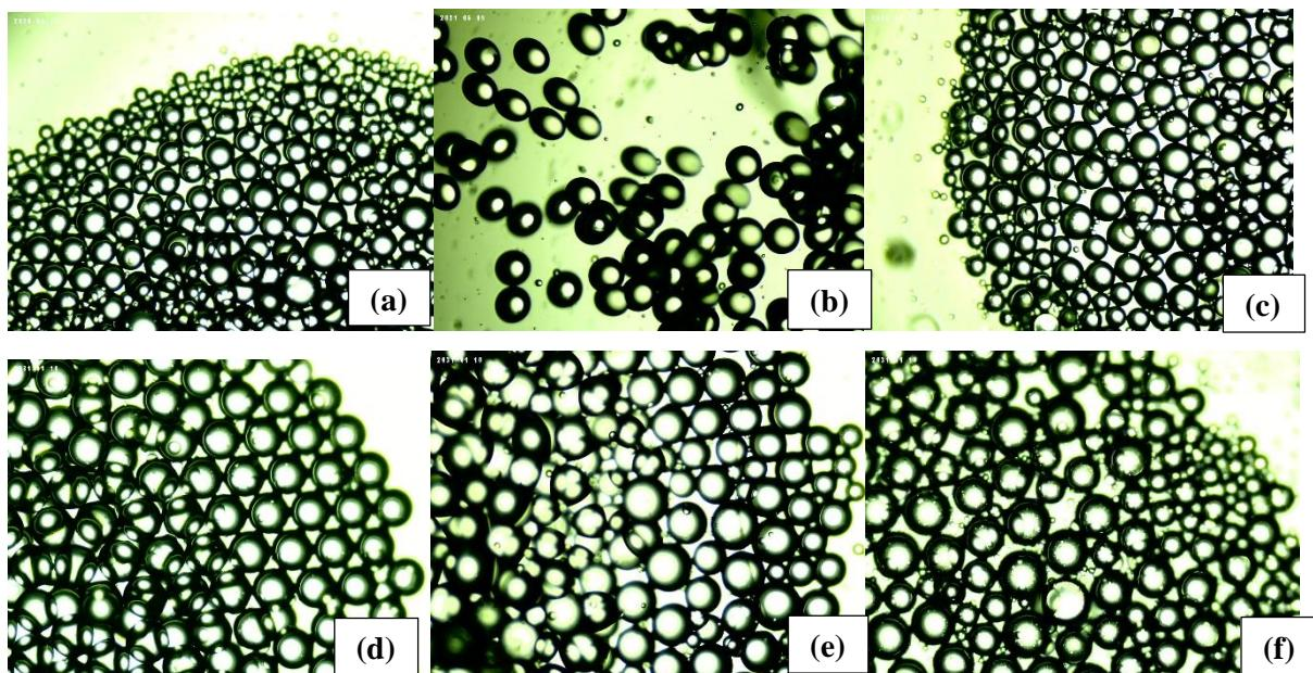
Slika 8. Fotografije mikroemulzija pripremljenih uz PEG 1500 kao emulgatorom pri ukupnom protoku od  $q = 400 \mu\text{L min}^{-1}$  : (a) ulje/voda, udio emulgatora 2%, udio ulja 30%; (b) ulje/voda, udio emulgatora 4 %, udio ulja 30 %; (c) ulje/voda, udio emulgatora 6 %, udio ulja 35 %; (d) ulje/vodenih ekstrakt mente, udio emulgatora 2 %, udio ulja 30 %; (e) ulje/vodenih ekstrakt mente, udio emulgatora 4 %, udio ulja 30 %; (f) ulje/vodenih ekstrakt mente, udio emulgatora 6 %, udio ulja 35 %
