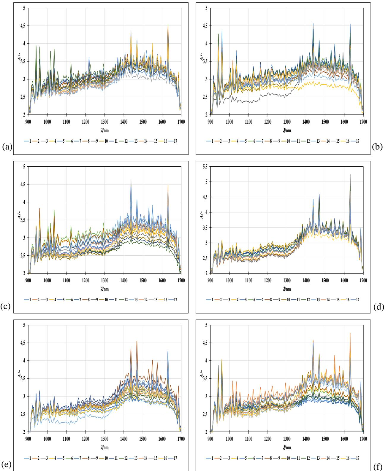
Slika 17. NIR spektri emulzija u sustavu : (a) ulje/voda uz PEG 1500, (b) ulje/voda uz PEG 6000, (c) ulje/voda uz PEG 2000, (d) ulje/voden ekstrakt mente uz PEG 1500, (e) ulje/voden ekstrakt mente uz PEG 6000, (f) ulje/voden ekstrakt mente uz PEG 20000
