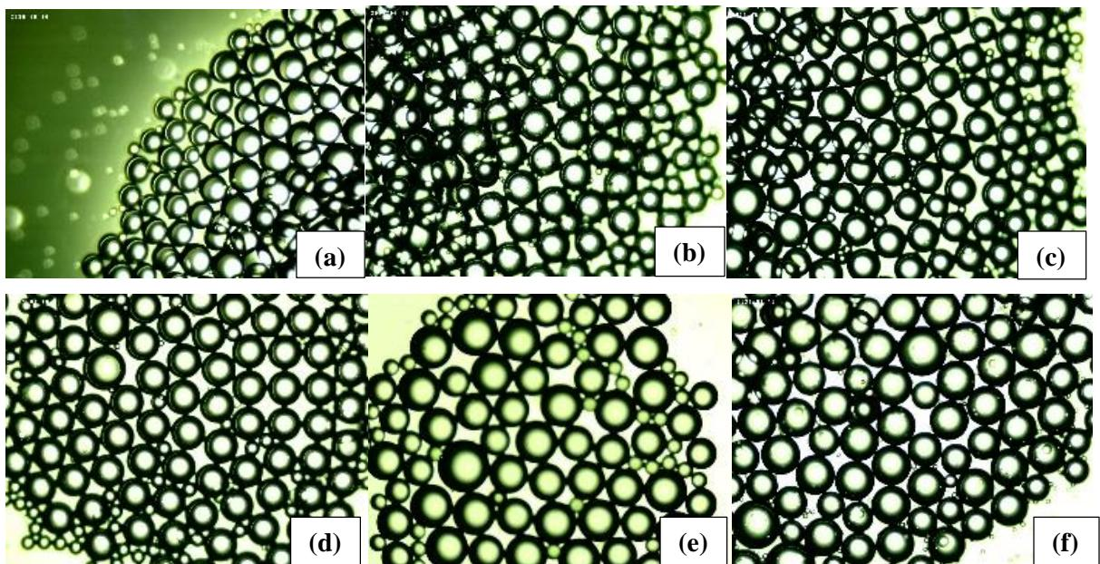
Slika 10. Fotografije mikroemulzija pripremljenih uz PEG 20 000 kao emulgatorom pri ukupnom protoku od  $q = 400 \mu\text{L min}^{-1}$  : (a) ulje/voda, udio emulgatora 2 %, udio ulja 30 %; (b) ulje/voda, udio emulgatora 4 %, udio ulja 30 %; (c) ulje/voda, udio emulgatora 6 %, udio ulja 35 %; (d) ulje/voden ekstrakt mente, udio emulgatora 2 %, udio ulja 30 %; (e) ulje/voden ekstrakt mente, udio emulgatora 4 %, udio ulja 30 %; (f) ulje/voden ekstrakt mente, udio emulgatora 6 %, udio ulja 35 %
