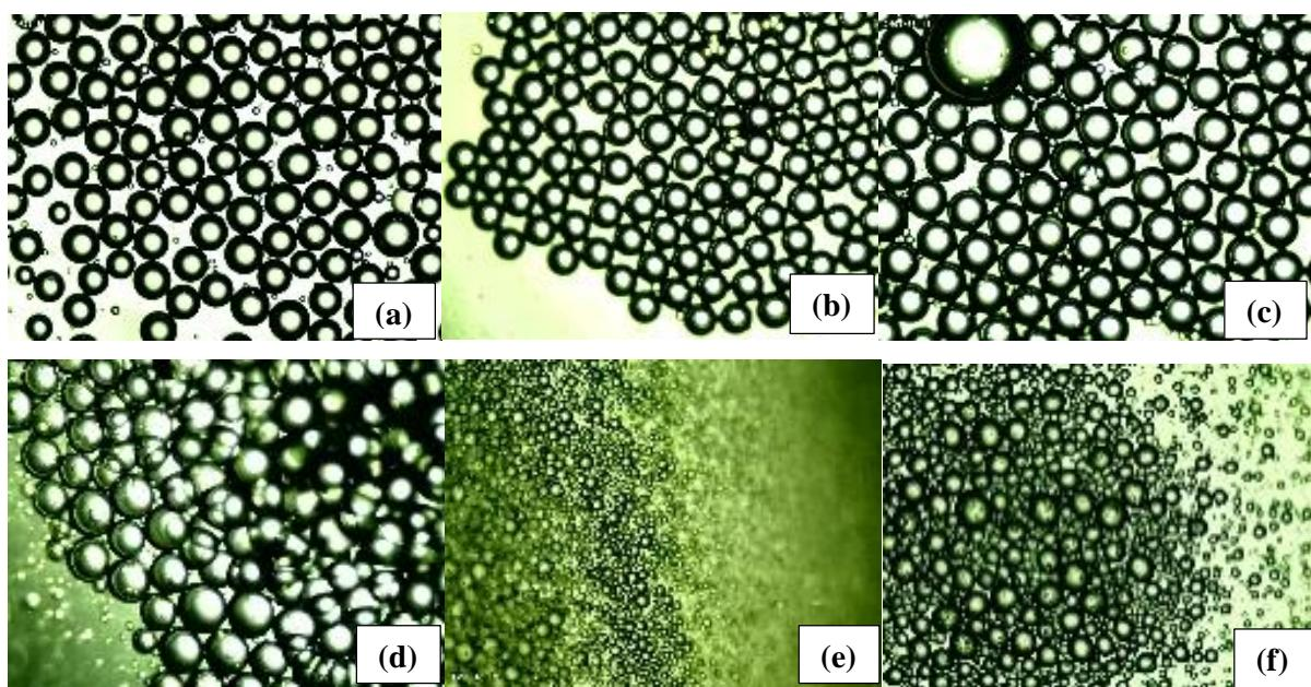
Slika 9. Fotografije mikroemulzija pripremljenih uz PEG 6000 kao emulgatorom pri ukupnom protoku od  $q = 400 \mu\text{L min}^{-1}$  : (a) voda/ulje, udio emulgatora 2%, udio ulja 30%; (b) ulje/voda, udio emulgatora 4 %, udio ulja 30 %; (c) ulje/voda e, udio emulgatora 6 %, udio ulja 35 %; (d) ulje/voden ekstrakt mente udio emulgatora 2 %, udio ulja 30 %; (e) ulje/voden ekstrakt mente, udio emulgatora 4 %, udio ulja 30 %; (f) ulje/voden ekstrakt mente, udio emulgatora 6 %, udio ulja 35 %
