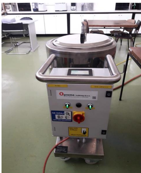
Slika 6. Šaržni pasterizator PS-100 (Burcar, 2019)
