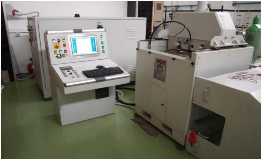
Slika 8. „Stansted Fluid Power“ Velika Britanija, uređaj za obradu visokim hidrostastkim tlakom\*
