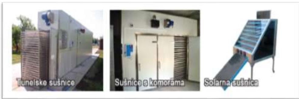
Slika 12. Vrste sušnica za sušenje ljekovitog i aromatičnog bilja
