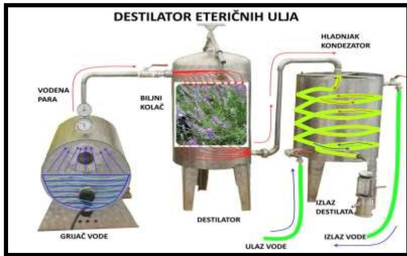
Slika 10. Shematski prikaz principa destilacije ljekovitog bilja u destilatoru
