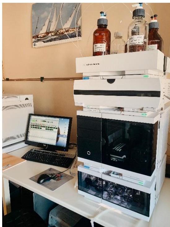
Slika 8. HPLC uređaj udružen s masenim spektrometrom s trostrukim kvadrupolom (vlastita fotografija)
