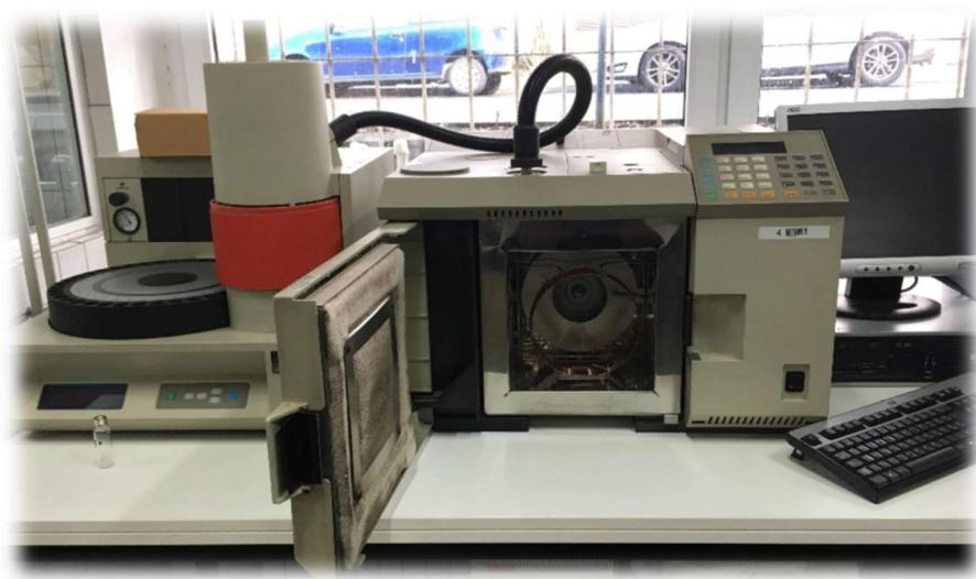
**Slika 3.** Plinski kromatogram „Perkin Elmer Autosystem XL-GC (Perkin Elmer, SAD) uz pripadajući sustav za uzorkovanje „Perkin Elmer Headspace Sampler 40XL“ (Perkin Elmer, SAD)
