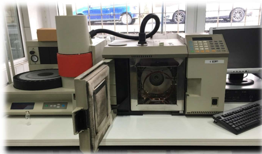
Slika 3. Plinski kromatogram „Perkin Elmer Autosystem XL-GC (Perkin Elmer, SAD) uz pripadajući sustav za uzorkovanje „Perkin Elmer Headspace Sampler 40XL“ (Perkin Elmer, SAD)
