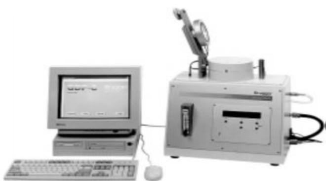
Slika 14. Uredaj za mjerenje propusnosti na plinove (GDP-C Brugger, Njemačka)
