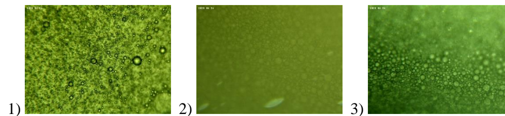
Slika 18. Mikroskopski prikaz kapljica emulzije ulje u vodenom ekstraktu lavande, s dodatkom emulgatora, pripremane pri optimalnim uvjetima – 1) PEG1500 2) PEG6000 3) PEG20000
