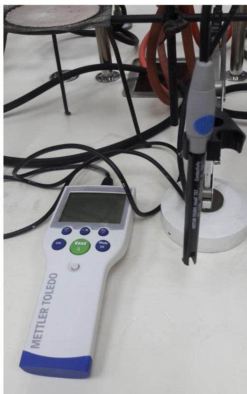
Slika 3. Mettler Toledo konduktometar s elektrodom (vlastita fotografija)
