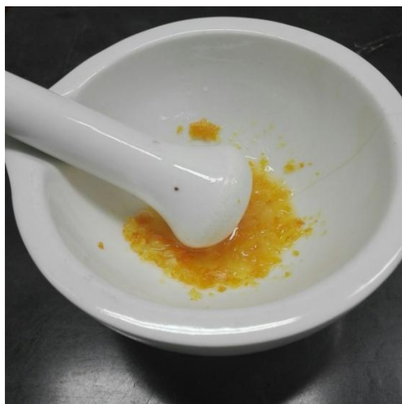
Slika 6. Homogenizacija narančine kore u tarioniku s tučkom (vlastita fotografija)
