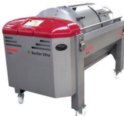
Slika 27. Pneumatska preša XPro 5 (Bucher Vaslin, 2012)
