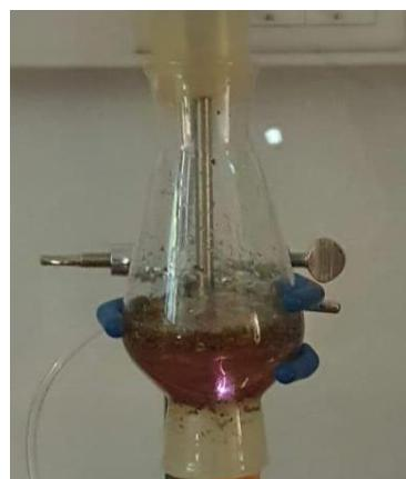
**Slika 8.** Visokonaponsko električno pražnjenje u otopini (vlastita fotografija)
