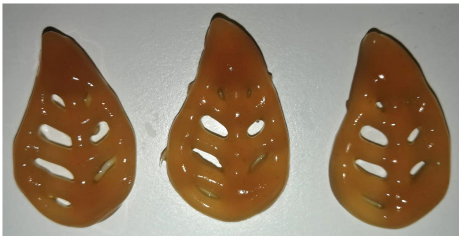
Slika 26. Razlike između 3D printanih alginatnih gelova s ekstraktom lista masline s obzirom na promjenu brzine printanja. (s lijeva na desno: uzorak 78 (4/0,8/50/100), 15 (4/0,8/100/100), 79 (4/0,8/150/100))
