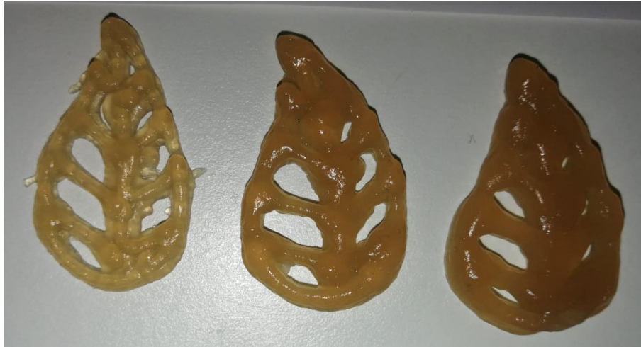
Slika 25. Razlike između 3D printanih alginatnih gelova s ekstraktom lista masline s obzirom na promjenu brzine ekstruzije. (s lijeva na desno: uzorak 30 (3/1,6/150/50)*, 4 (3/1,6/150/100), 14 (3/1,6/150/150)). *Vrijednosti u zagradi označavaju sljedeće: koncentracija alginata/promjer nastavka/brzina printanja/brzina ekstruzije
