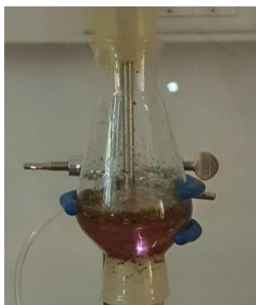
Slika 8. Visokonaponsko električno pražnjenje u otopini (vlastita fotografija)
