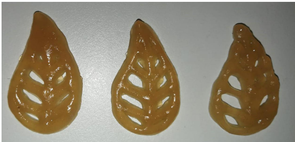
Slika 28. Razlike između 3D printanih alginatnih gelova s ekstraktom lista masline s obzirom na promjenu promjera nastavka. (s lijeva na desno: uzorak 42 (3/0,8/150/100), 31 (3/1,2/100/100), 38 (3/1,6/100/100))
