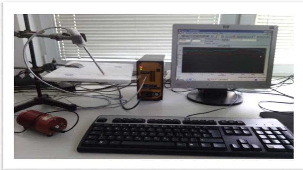
Slika 37. NIR instrument spojen na računalo sa instaliranim programom SPEC-32 (a), izvor zračenja (b) i sonda (c)
