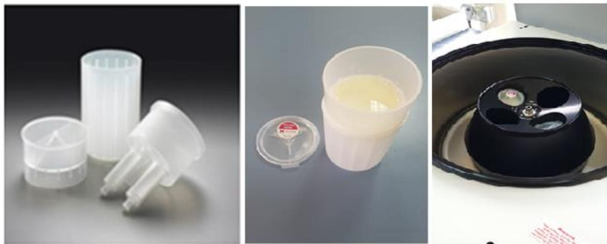
**Slika 13.** Uklanjanje kompleksa  $\beta$ -glukan-AFM1/metali iz mlijeka centrifugiranjem u filtru Centricon Plus-70, MWCO 100 kDa (vlastita fotografija)
