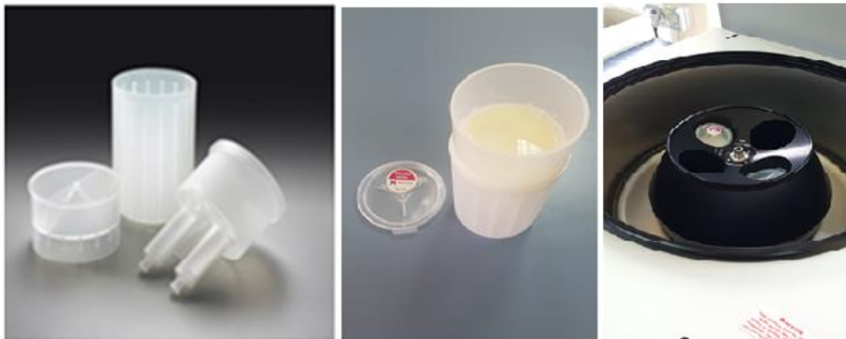
Slika 13. Uklanjanje kompleksa \beta -glukan-AFM1/metali iz mlijeka centrifugiranjem u filteru Centricon Plus-70, MWCO 100 kDa (vlastita fotografija)
