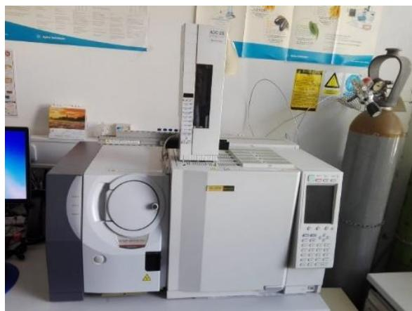
**Slika 15.** Uređaj za plinsku kromatografiju s masenom spektrometrijom (GC-MS) QP 2010 Plus
