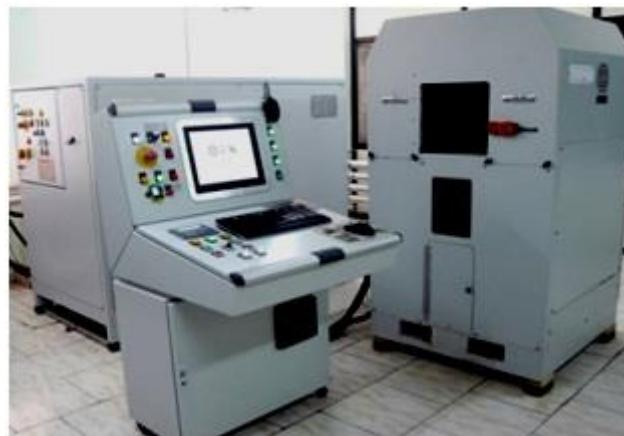
**Slika 21.** Uredaj za ekstrakciju potpomognutu visokim hidrostatskim tlakom (Anonymous, 2017)
