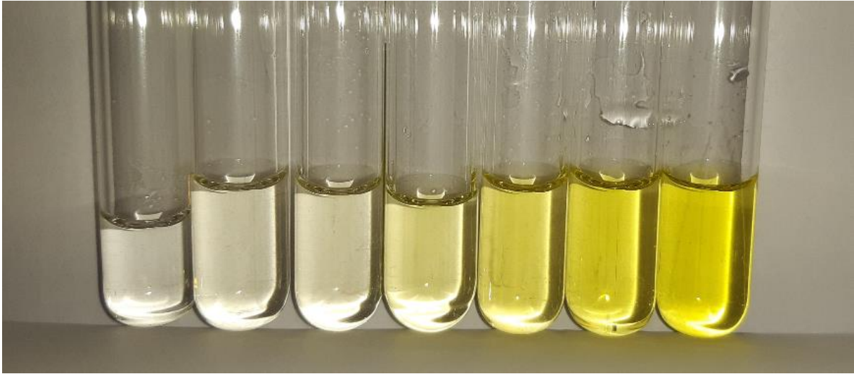
Prilog 1. Obojenja reakcije PAHBAH metode za slijepu probu te rastuće koncentracije standarda fruktoze (5, 10, 25, 50, 75 i 100 mg ml -1 , s lijeva na desno)
