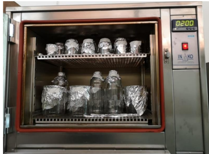
Slika 9. Suha sterilizacija laboratorijskog posuđa (vlastita fotografija)
