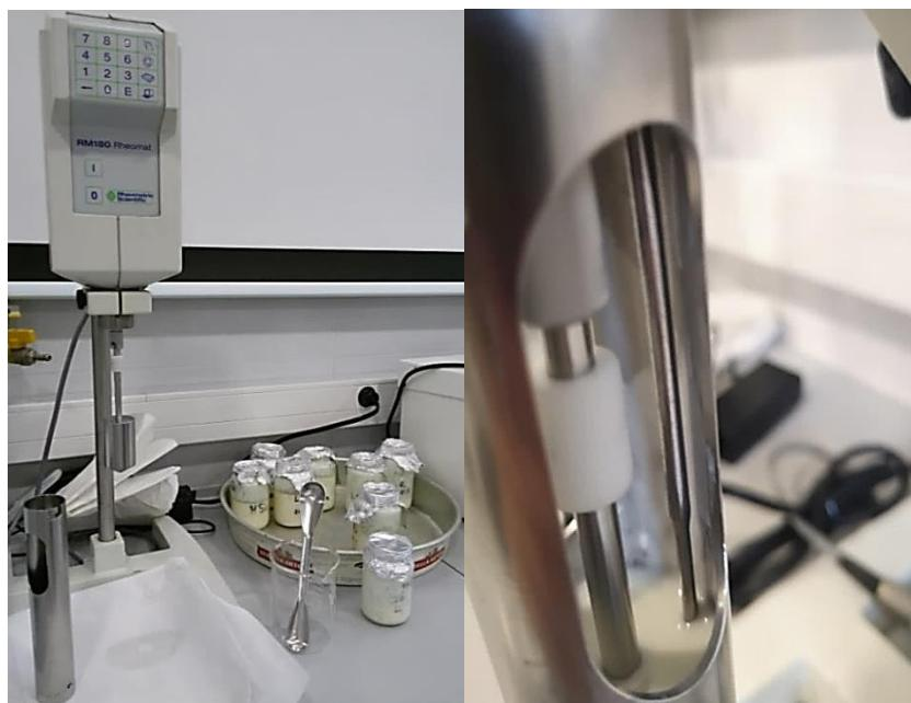
Slika 13. Reometar korišten za određivanje viskoznosti u uzorcima jogurta: lijevo – priprema za mjerjenje, desno – tijekom mjerjenja (vlastita fotografija)
