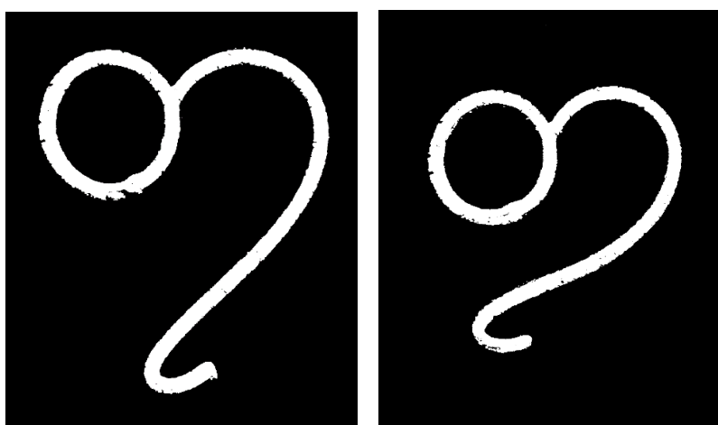
Slika 21. Binarna fotografija 3D tiskanog oblika nakon tiskanja (lijevo) i nakon pečenja (desno)
