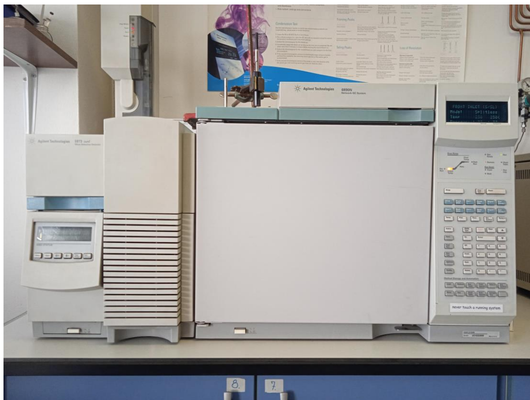
Slika 4. Plinski kromatograf kromatografu Agilent Technologies 6890N Network GC System (vlastita fotografija).
