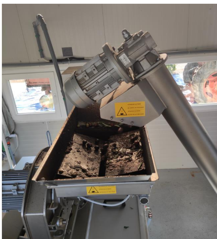
Slika 15 – Transport očišćenih maslina pomoću elevatora u sklopu Oliomio 200 Profy stroja (izvor: vlastita fotografija)
