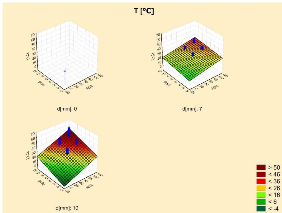
Slika 15. 3D dijagram ovisnosti utjecaja procesnih parametara na  $T [^{\circ}\text{C}]$  sistematizirano prema promjeru sonde
