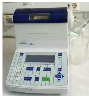
Slika 8. Uređaj za mjerjenje gustoće „Mettler Toledo Density Meter DE 40“, Švicarska
