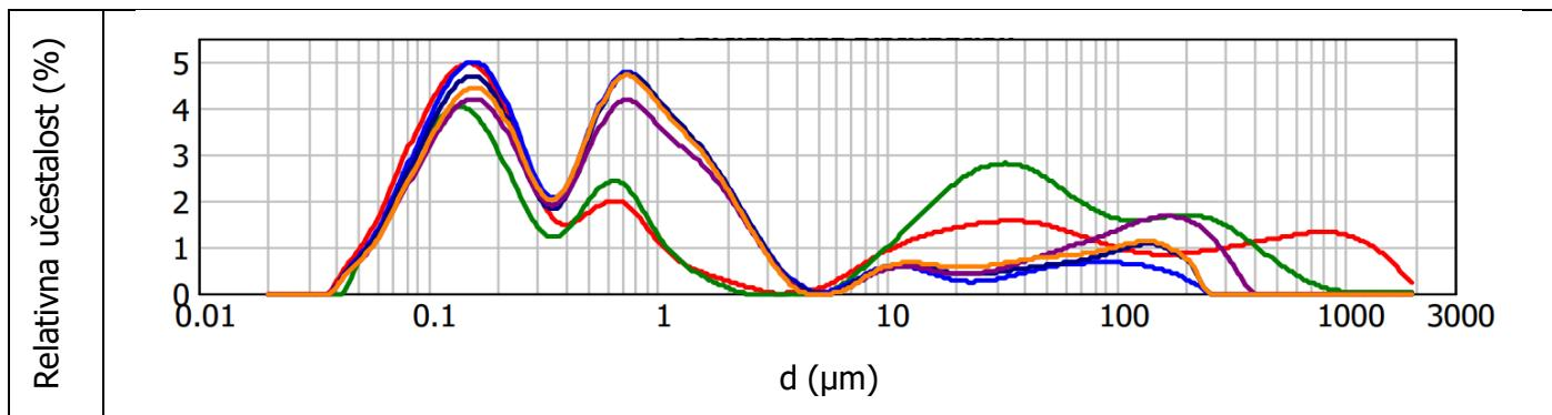
Slika 20. Raspodjela veličine čestica ( $\mu\text{m}$ ) pri amplitudi od 60 % u vremenu obrade od 6 ili 10 minuta sa sondom 7 mm i vremenom usitnjavanjem od 15 ili 45 sekundi u ovisnosti o relativnoj učestalosti (%)
