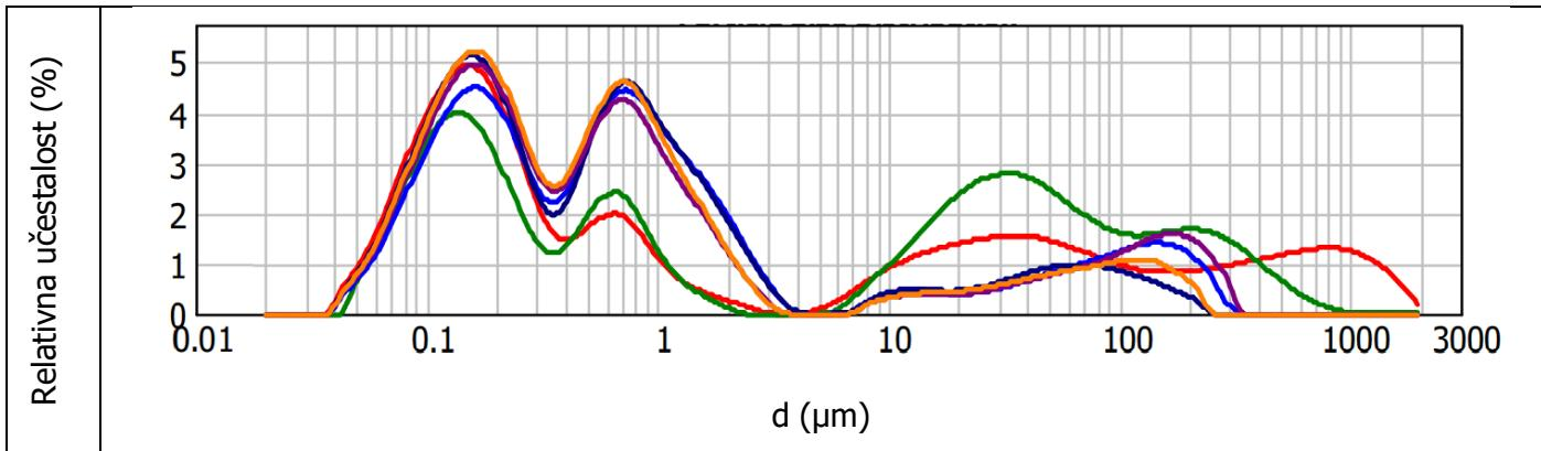
Slika 22. Raspodjela veličine čestica ( $\mu\text{m}$ ) pri amplitudi od 100 % u vremenu obrade od 6 ili 10 minuta sa sondom 7 mm i vremenom usitnjavanjem od 15 ili 45 sekundi u ovisnosti o relativnoj učestalosti (%)
