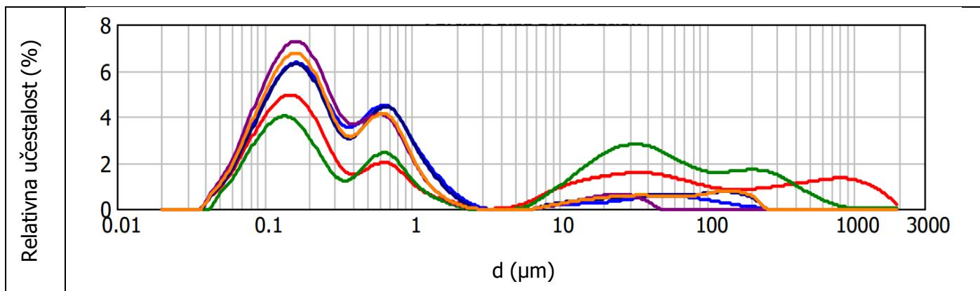
Slika 23. Raspodjela veličine čestica ( $\mu\text{m}$ ) pri amplitudi od 100 % u vremenu obrade od 6 ili 10 minuta sa sondom 10 mm i vremenom usitnjavanjem od 15 ili 45 sekundi u ovisnosti o relativnoj učestalosti (%)
