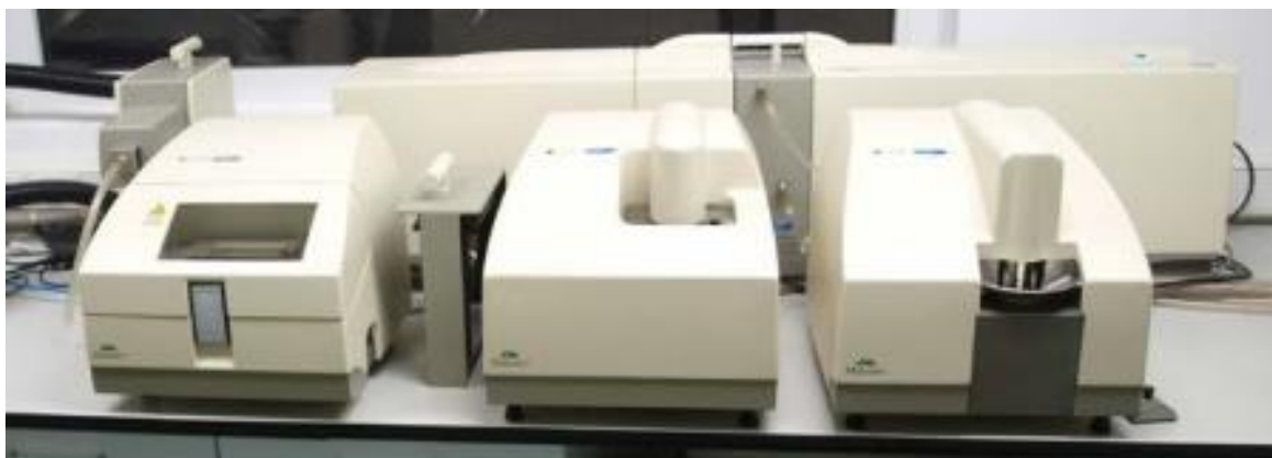
Slika 9. „Malvern Mastersizer 2000“ s vanjskom jedinicom Hydro 2000S
