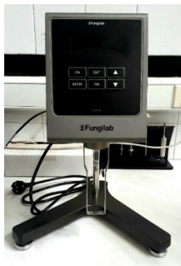
Slika 7. Uređaj za mjerenje viskoznosti „Fungilab ALPHA“
