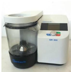
Slika 4. Uređaj za usitnjavanje „RETSCH GM 300“
