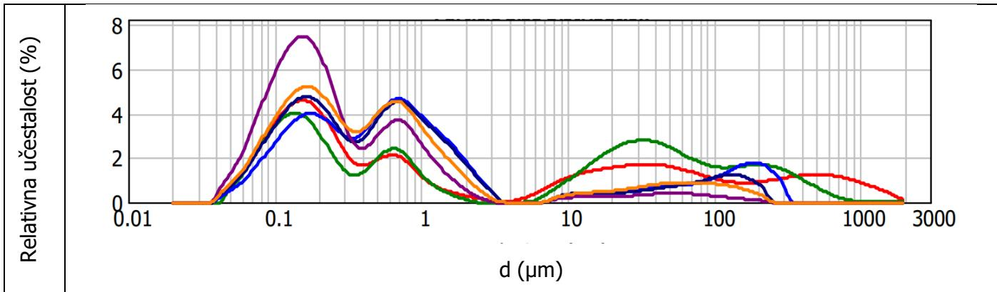
Slika 21. Raspodjela veličine čestica ( $\mu\text{m}$ ) pri amplitudi od 60 % u vremenu obrade od 6 ili 10 minuta sa sondom 10 mm i vremenom usitnjavanjem od 15 ili 45 sekundi u ovisnosti o relativnoj učestalosti (%)
