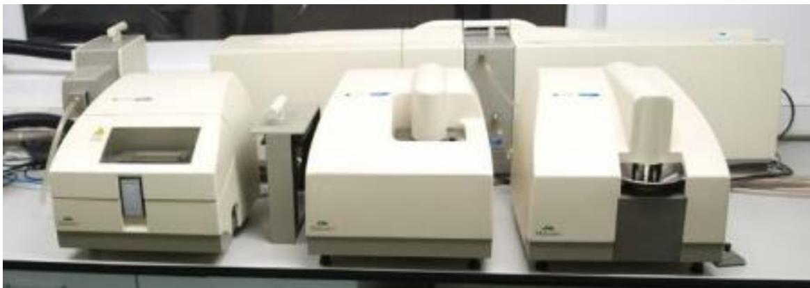
Slika 9. „Malvern Mastersizer 2000“ s vanjskom jedinicom Hydro 2000S
