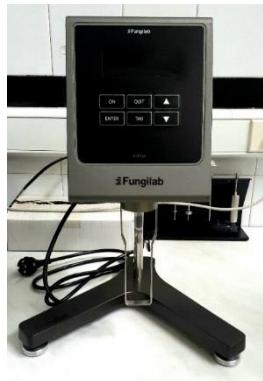
Slika 7. Uređaj za mjerjenje viskoznosti „Fungilab ALPHA“
