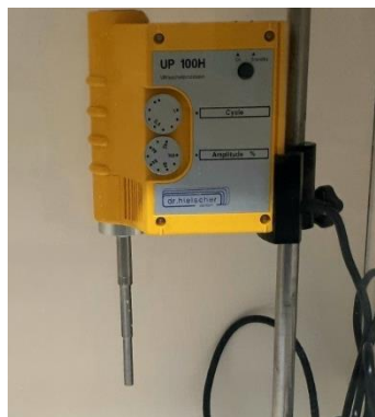
Slika 5. Ultrazvuk „Dr. Hielscher UP100H“
