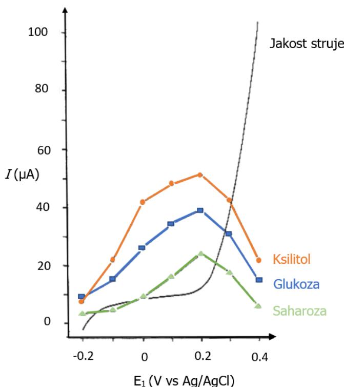
**Slika 12.** Jakost struje ( $I$ ,  $\mu$ A), koja nastaje uslijed oksidacije triju različitih spojeva pri različitim vrijednostima potencijala  $E_1$  (V) (prilagođeno iz Rohrer, 2013).
