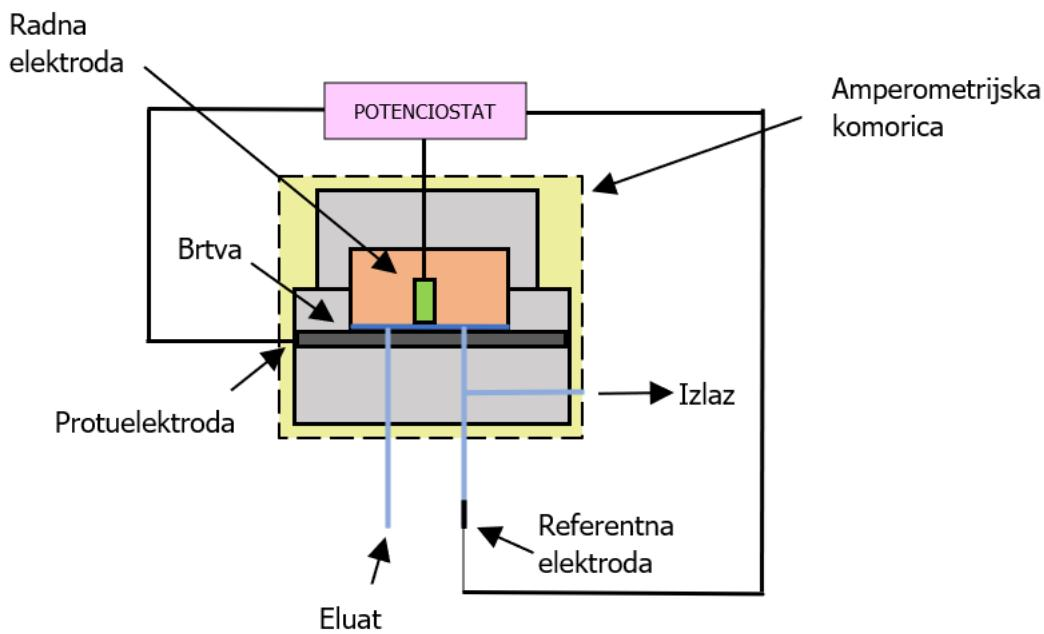
**Slika 3.** Amperometrijski detektor (prilagođeno iz Bolanča i Ukić, 2013).
