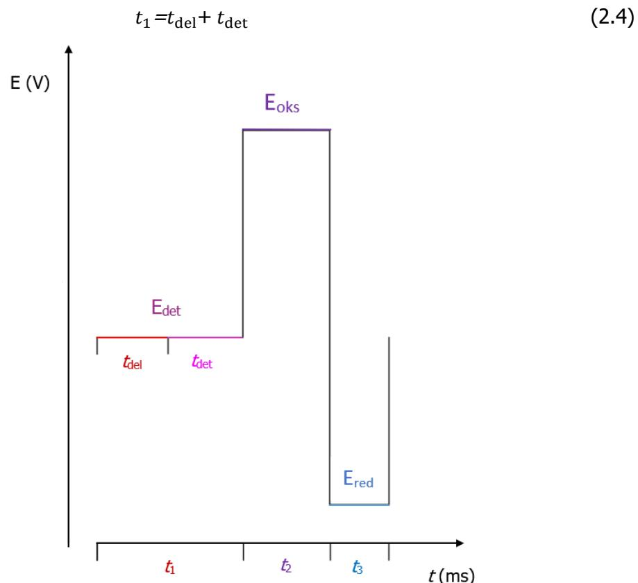
**Slika 13.** Tri naizmjenična potencijala ( $E_1 = E_{\text{det}}$ ;  $E_2 = E_{\text{oks}}$ ;  $E_3 = E_{\text{red}}$ ) koji se izmjenjuju tijekom detekcije ugljikohidrata HPAE-PAD metodom kroz vremena  $t_1$  ( $t_1 = t_{\text{del}} + t_{\text{det}}$ ),  $t_2$  ( $t_{\text{oks}}$ ) i  $t_3$  ( $t_{\text{red}}$ ) (prilagođeno prema Corradini i sur., 2012).
