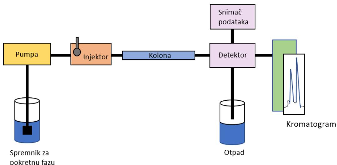
**Slika 2.** Shematski prikaz HPLC sustava.
