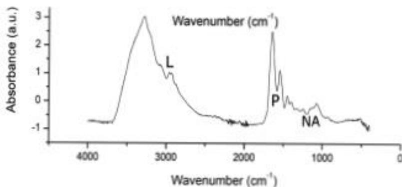
**Slika 8.** Najvažnije makromolekule u spektru sline: L- lipidi ( $3000\text{-}2800\text{ cm}^{-1}$ ), P- proteini (amidne skupine,  $1700\text{-}1600$  i  $1560\text{-}1500\text{ cm}^{-1}$ ) i NA- nukleinske kiseline ( $1200\text{-}1000\text{ cm}^{-1}$ ) [14].
