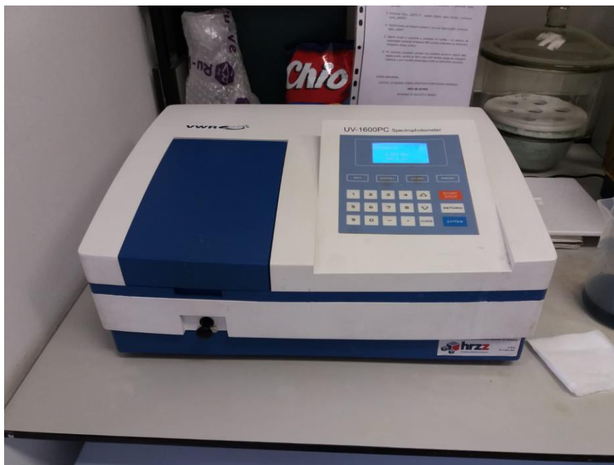
Slika 3. UV/VIS spektrofotometar – VWR UV-1600PC Spectrophotometer (vlastita fotografija)
