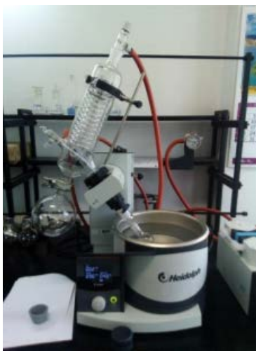
Slika 7. Otparavanje na rotavaporu (Bosotin, 2016)
