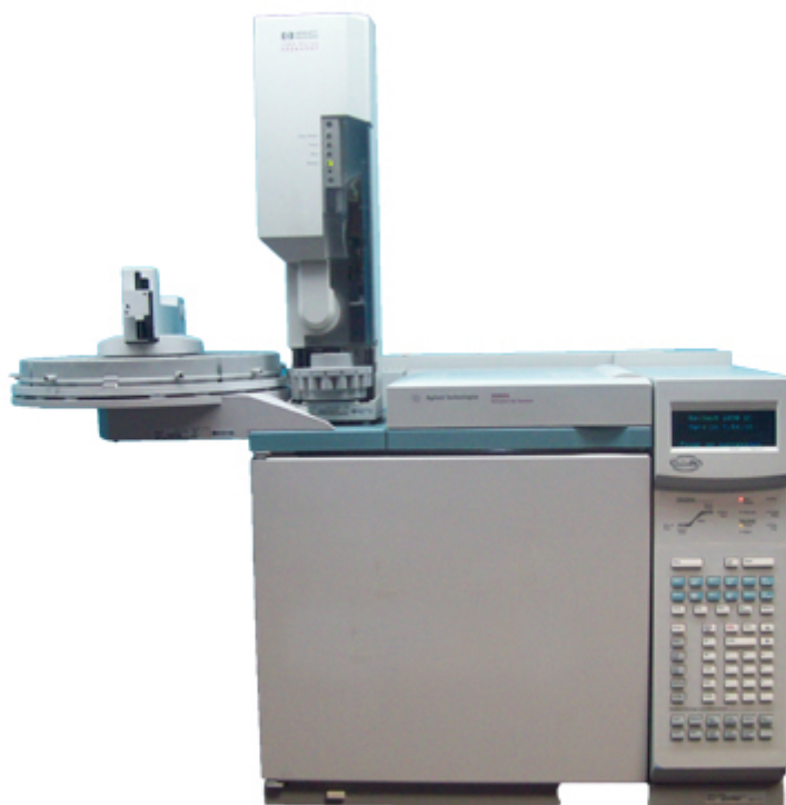
Slika 10. Plinski kromatograf (Anonymous 3, 2021)
