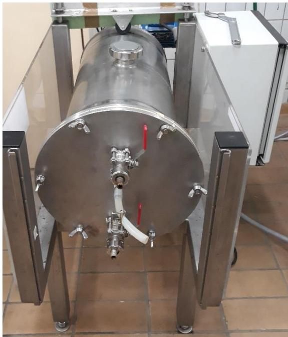
**Slika 6.** Horizontalni rotirajući cijevni bioreaktor (HRCB)
