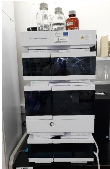
**Slika 4.** Uređaj za tekućinsku kromatografiju ultra djelotvornosti (UPLC)
