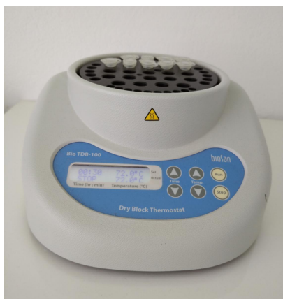
Slika 11. Termostatiranje uzoraka za qRT-PCR pomoću Dry block thermostat Bio TDB-100 (BioSan, Riga, Latvija) [vlastita fotografija].
