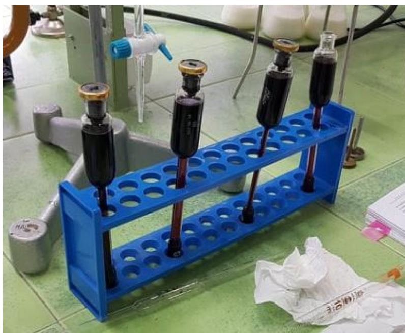
Slika 10. Određivanje mliječne masti (vlastita fotografija)
