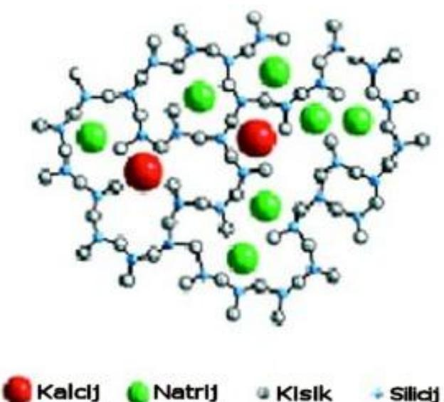
Slika 2: Struktura stakla (www.glaz.hr)
