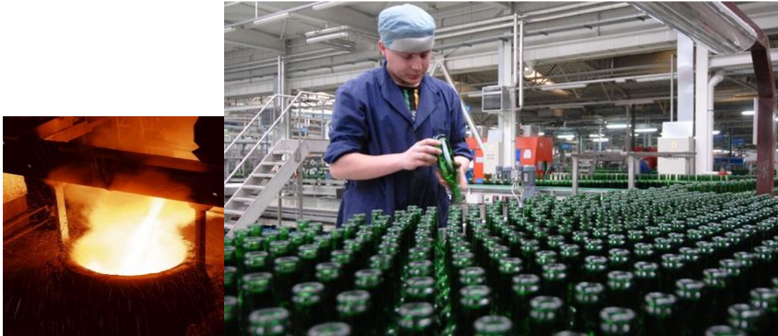
Slika 1: Taljenje, fomiranje i kontrola boca ( www.veleri.hr ).
