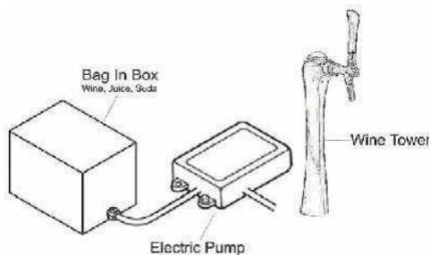
**Slika 17:** Bag in Box spojen na „šank-aparat“ (Rapp, 2005).
