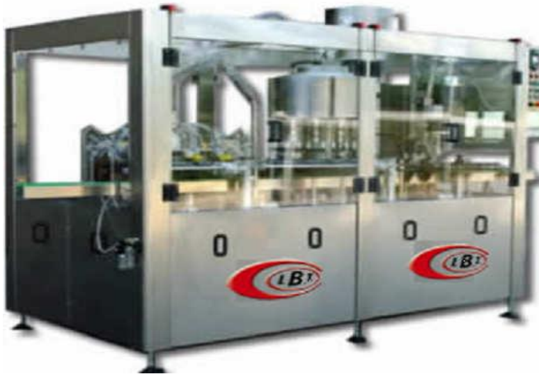
Slika 9: Punilica za sterilno punjenje ( www.veleri.hr )
