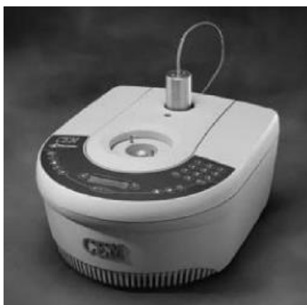
Slika 16. Jednofunkcijski mikrovalni reaktor (Zrinski i Eckert-Maksić, 2005)
