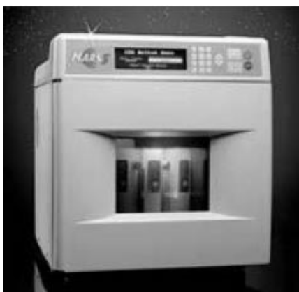
Slika 17. Višefunkcijski mikrovalni reaktor (Zrinski i Eckert-Maksić, 2005)
