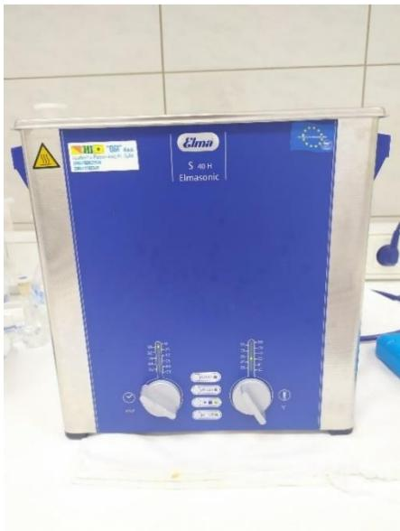
**Slika 8.** Ultrazvučna kupelj (vlastita fotografija)
