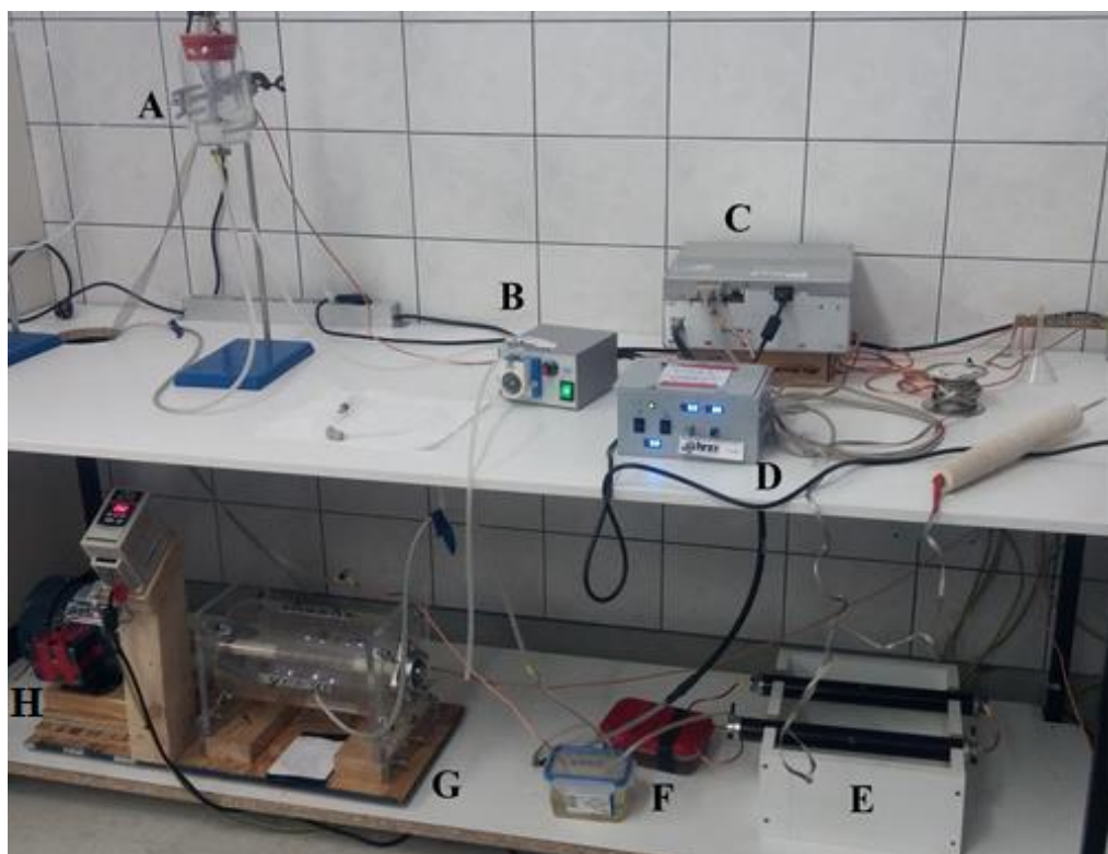
Slika 7. Sustav za generiranje plazme u tekućini visokonaponskim pražnjenjem: A) reaktor, B) pumpa, C) visokonaponski generator D) kontrolna jedinica za napajanje, E) otpornici 9,5 M \Omega F) kondenzator 0,75 nF G) rotirajuća sklopka, H) elektromotor s regulatorom frekvencije.
