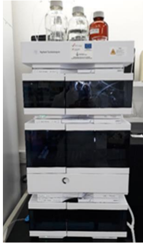
Slika 9. Uređaj za tekućinsku kromatografiju ultravisoke djelotvornosti (UPLC) (vlastita fotografija)
