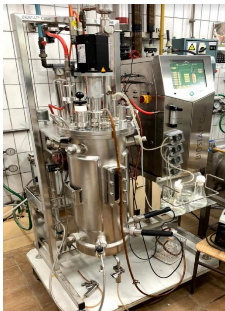
Slika 8. Bioreaktor s miješalom Biostat Cplus (vlastita fotografija)
