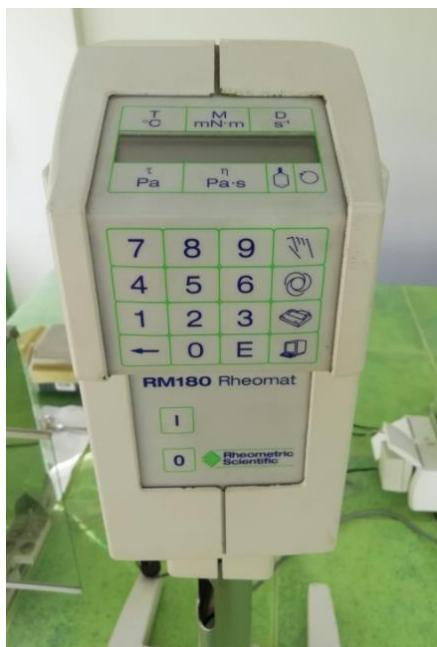
Slika 8. Rotacijski reometar za mjerjenje viskoznosti: sučelje (vlastita fotografija)
