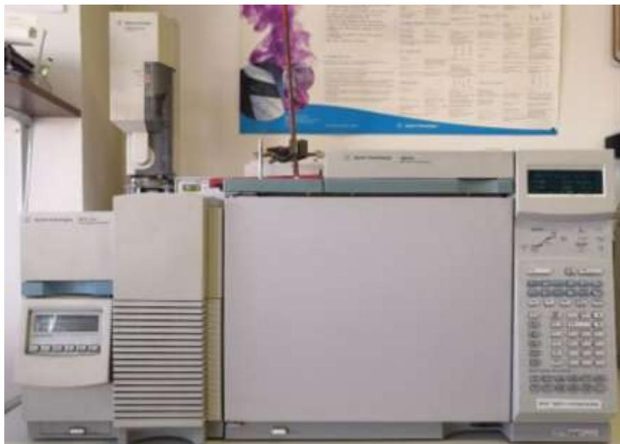
Slika 12. Plinski kromatograf s masenim spektrometrom (vlastiti izvor)
