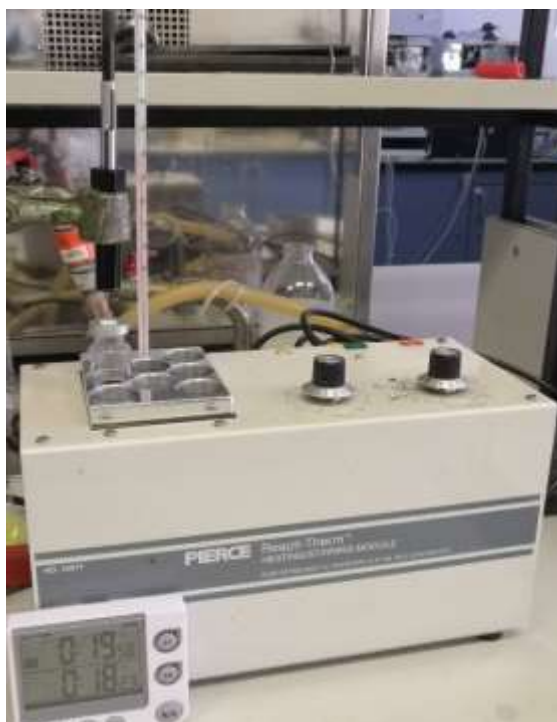
Slika 11. Termoblok s magnetskom mješalicom (vlastiti izvor)
