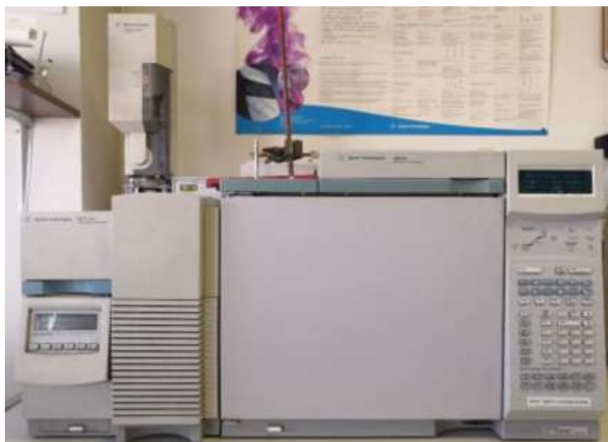
Slika 12. Plinski kromatograf s masenim spektrometrom (vlastiti izvor)
