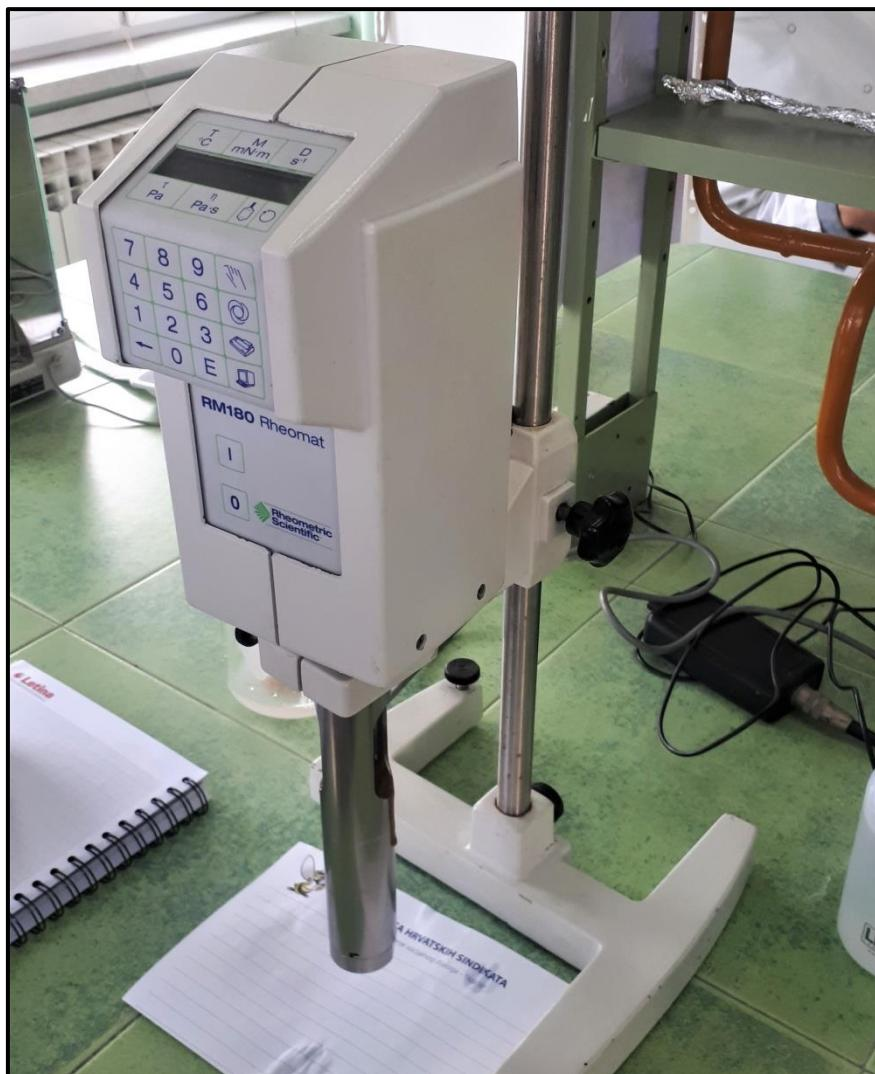
**Slika 7.** Rotacijski reometar RM-180, Rheometric Scientific (vlastita fotografija)
