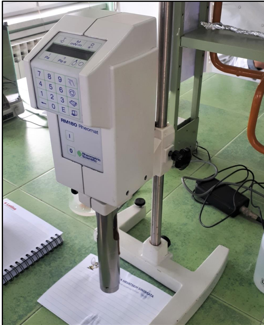
Slika 7. Rotacijski reometar RM-180, Rheometric Scientific (vlastita fotografija)
