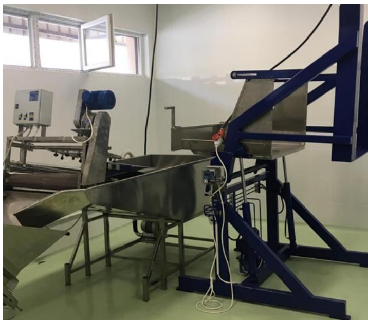
Slika 13. Uređaj za istresanje iz boks palete IP 1000 (Euclid, 2021)
