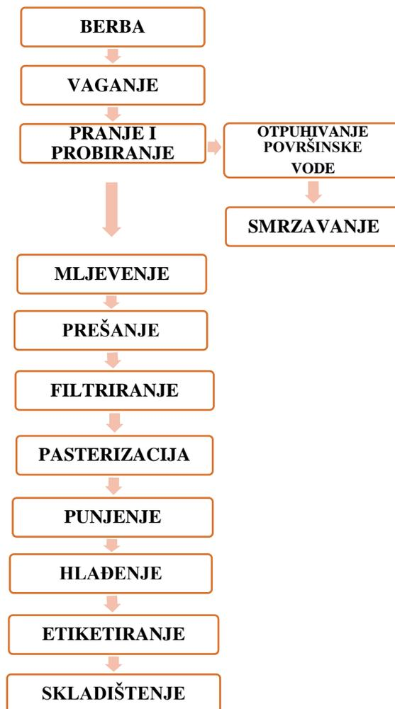
Slika 10. Shema proizvodnje soka iz bobičastog voća u planiranom objektu (vlastita shema)
