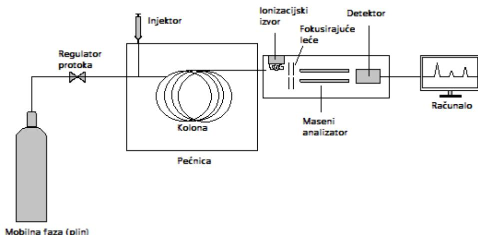
**Slika 4.** Shematski prikaz GC/MS uređaja (Prilagođeno prema Shimadzu, 2020)
