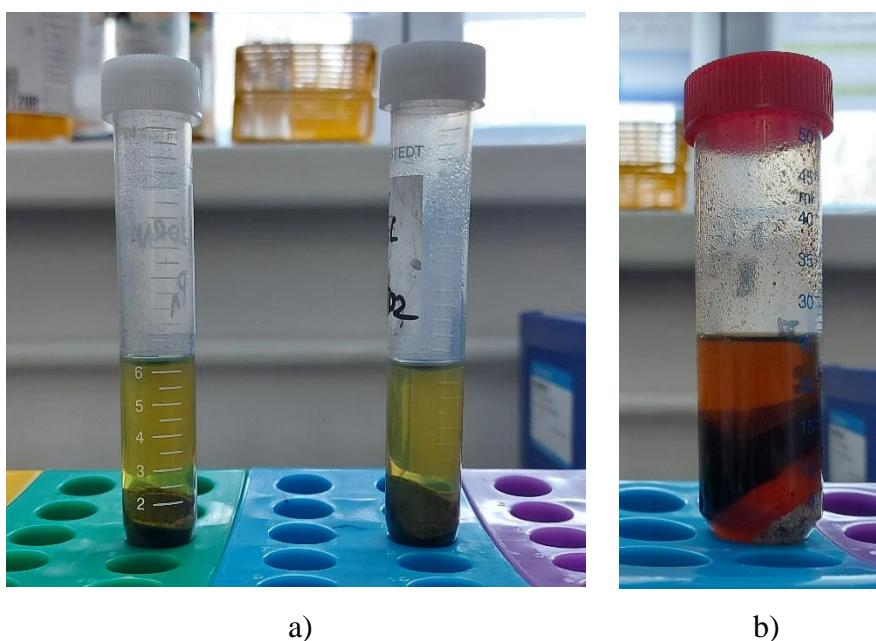
**Slika 8.** Pripremljeni uzorci za analizu pesticida na GC-MS/MS-u (a) te na LC-MS/MS-u (b)
