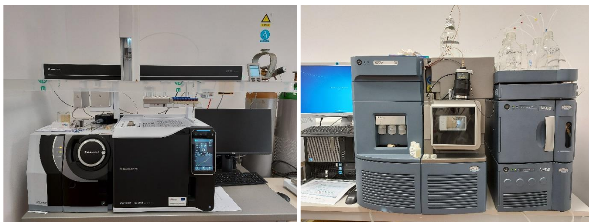
Slika 9. Instrument GC-MS/MS (a) i LC-MS/MS (b) korišteni za određivanje ostataka pesticida (Vlastite fotografije)
