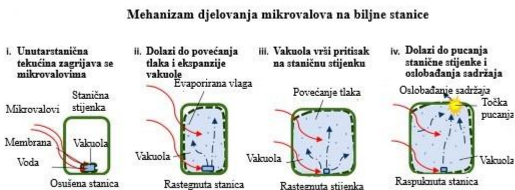
Slika 4. Mehanizam djelovanja mikrovalova na biljne stanice (prema Chan i sur., 2016).
