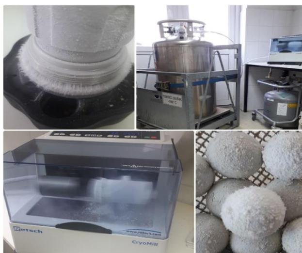
Slika 5. Kriomlin, spremnik s tekućim dušikom, kuglice i spremnik za uzorak (vlastita fotografija)
