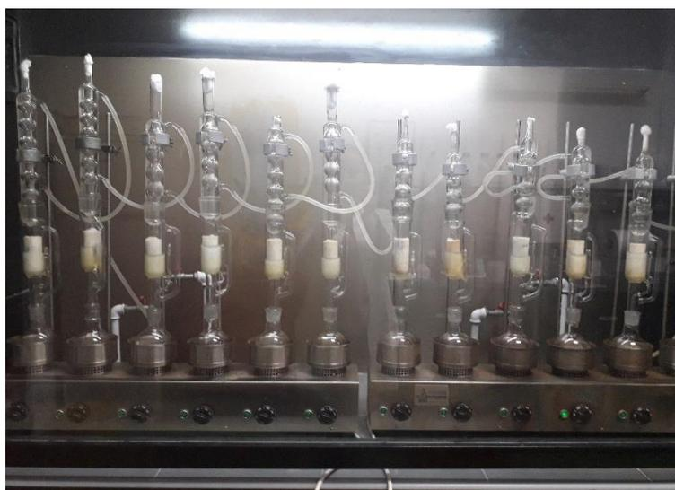
Slika 9. Aparatura po Soxhletu (vlastita fotografija)
