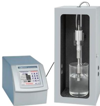
**Slika 10.** Ultrazvučni uređaj Q700 (Sonicator, 2021)
