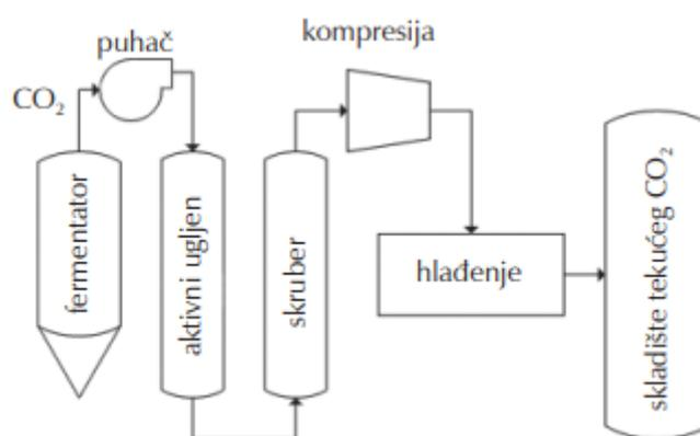
Slika 4. Shematski prikaz postrojenja za rekuperaciju CO<sub>2</sub> (Matijašević, 2015)
